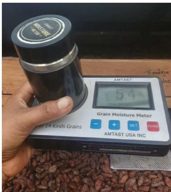
Figura 3. Dispositivos digitales utilizados para la medición de humedad del grano de cacao.
