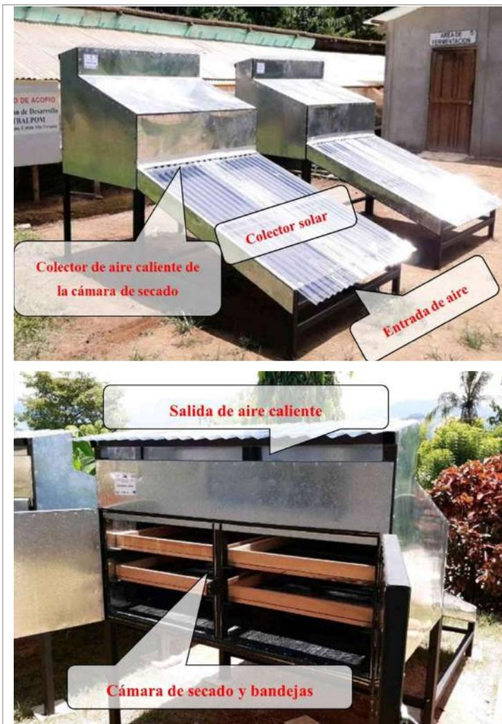
Figura 1. Secadores solares alternativos instalados en las asociaciones.
