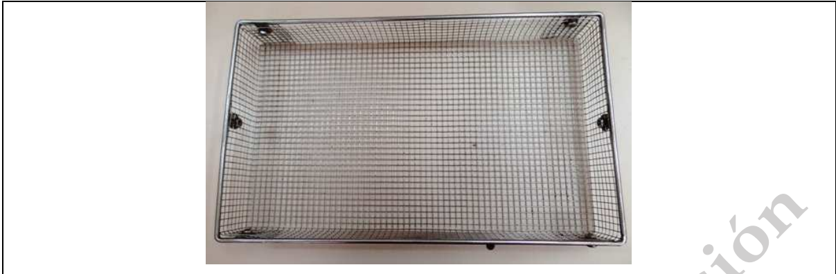
Figura 3. Bandeja de tostado de malla de acero inoxidable (Crédito: Sukha and Ali, 2016)
