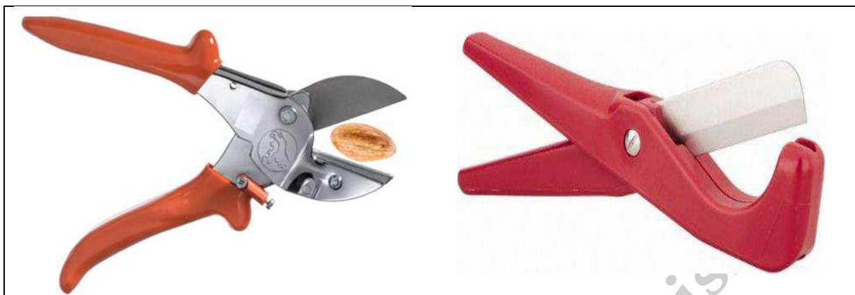
Figura 2. Ejemplo de herramientas usadas para cortar granos individualmente. Izquierda: Tijeras de podar de yunque (*anvil*); Derecha: Cortador de tubería plástica.
